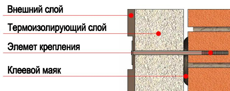
Длина дюбель-зонта выбирается таким образом, чтобы в основание стены он проникал на глубину  $40\div 65\text{мм}$ , а шуруп по дереву при варианте стен из ячеистого бетона на  $50\div 70\text{мм}$ .
