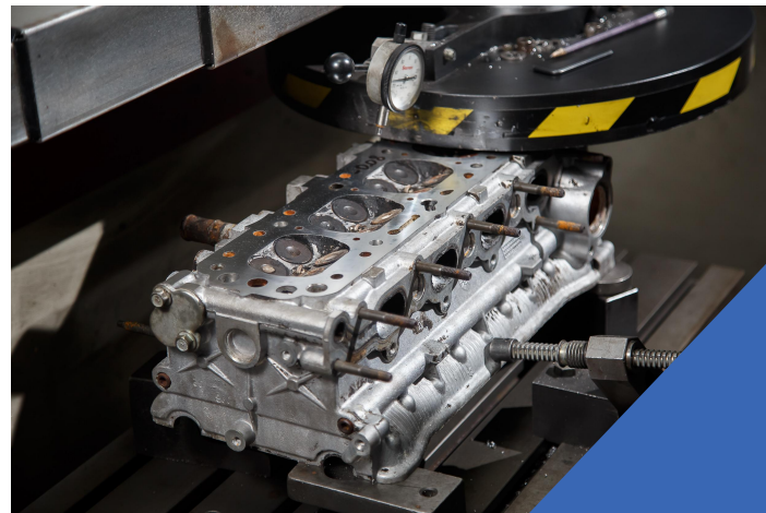
Станок «Rottler» S 8 M (США) - обработка привальных плоскостей ГБЦ, БЦ
