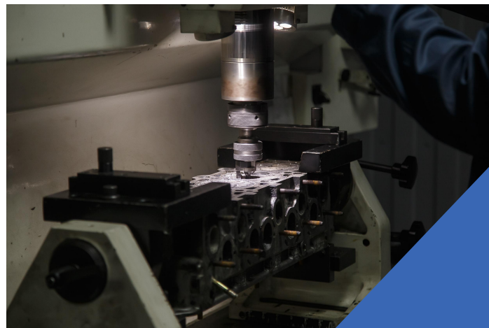
Станок «Rottler» SG 9 MTS (США) - обработка седел клапанов
